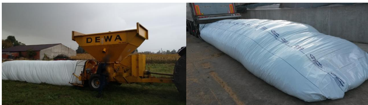
Figuur 6. Aanmaak van de worstsilo d. m. v. een trechtereuvuller (links) of een slurfaut0 (rechts).
