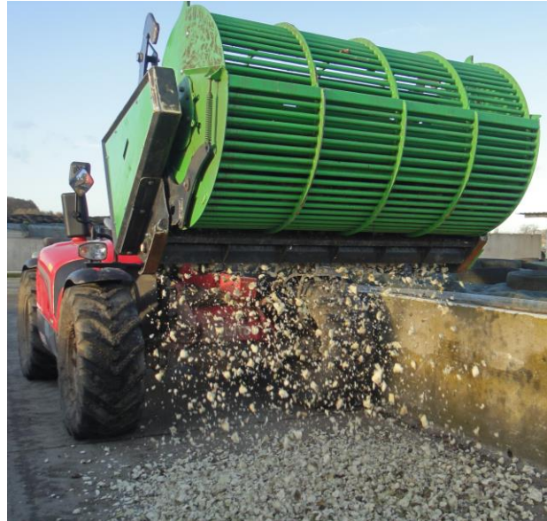
Figuur 3. Bietenreinigingsmand met versnijder: links is het kliksysteem te zien dat de standen (scheppen, reinigen of versnijden) aangeeft.
