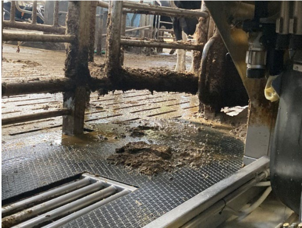
Foto 5 en 6: Opstapeling van vuil in de melkbox vormt een risico voor vuildeeltjes die op speenbekers en in de melk kunnen geraken
