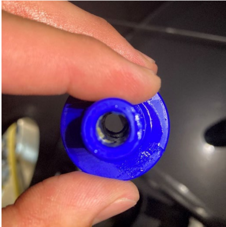
Foto 23: Vervuiling in de geleidingsring van voelsonde van de koeltank.
