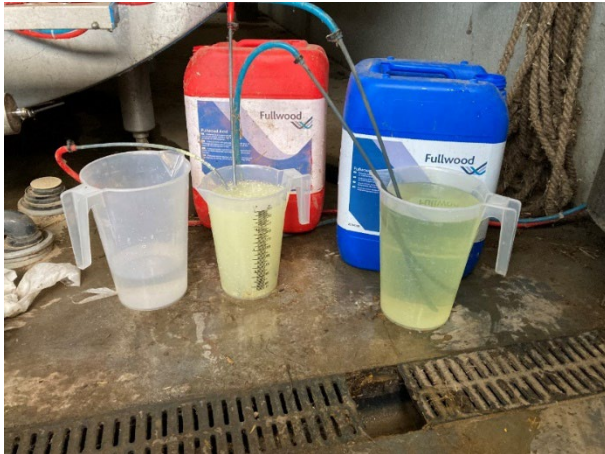
Foto 14: Bij controle van opname van reinigingsmiddel werd terugvloeï van melk in zuur reinigingsmiddel vastgesteld, wat de goede werking van het reinigingsmiddel teniet doet (zie middelste maatbeker).
