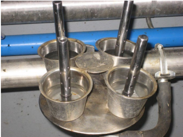
Foto 16: Restwater blijft achter in spoeljetters na spoeling.
