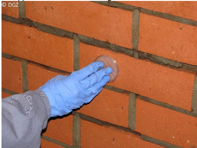
Figuur 2. Druk het afdrukplaatje gedurende 15 seconden met gelijke druk op het te bemonsteren droog oppervlak. Dit zonder de binnenzijde van het plaatje met de handen aan te raken (bron: DGZ)
