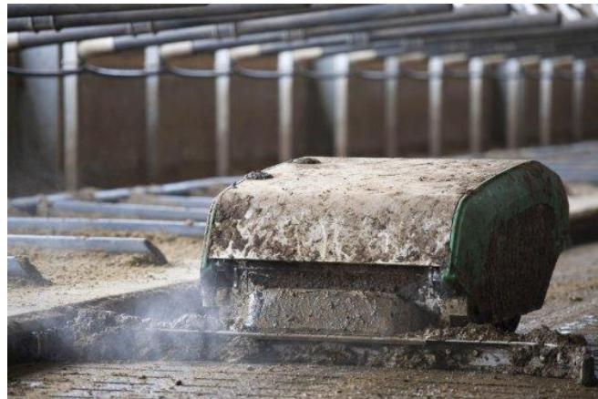
Figuur 5 Water vernevelen in de stal d.m.v. een sproeisysteem gekoppeld aan de mestrobot (Boerderij.nl, sd)
