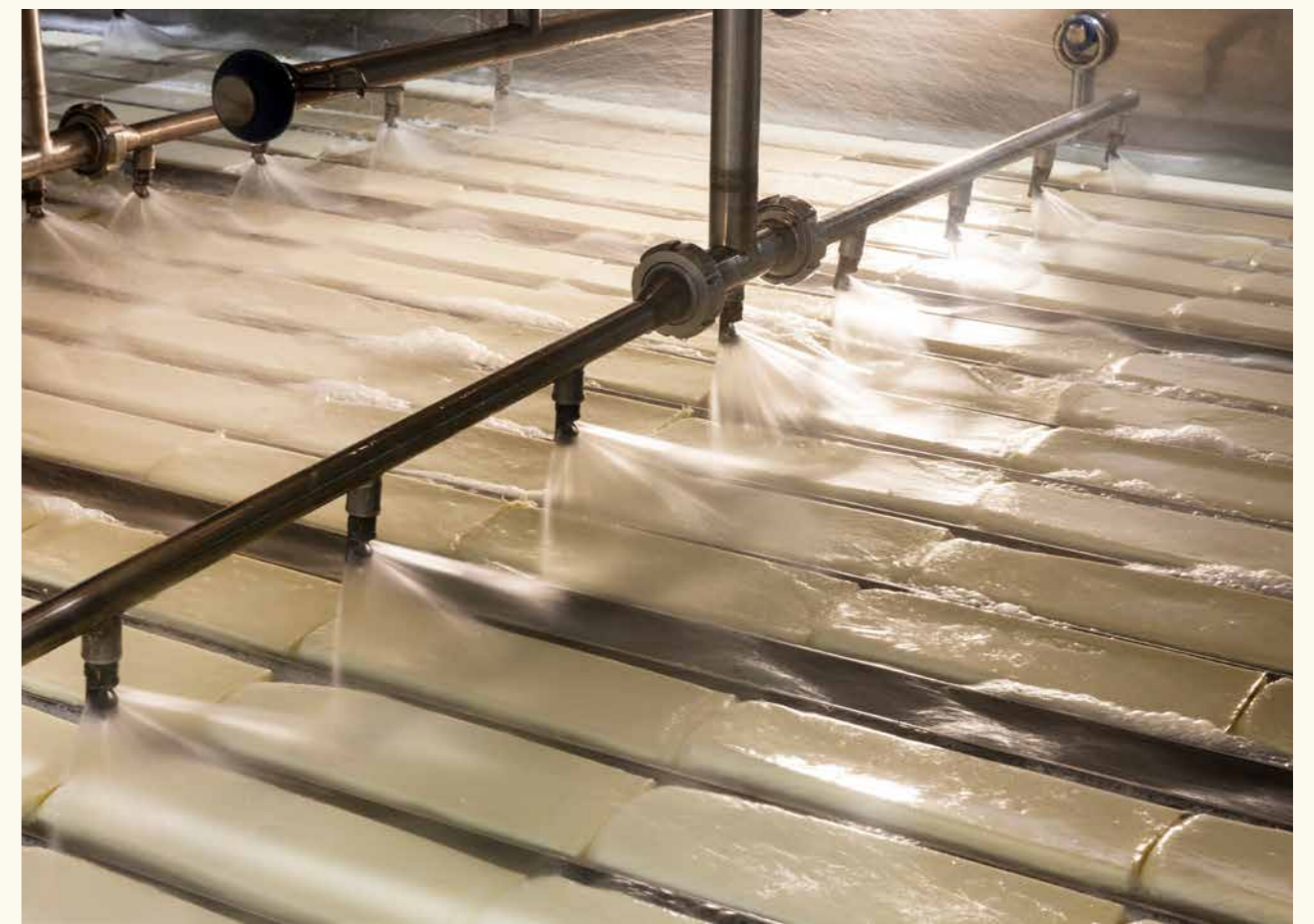
Pekkelbad in de kaasfabriek van Milcobel.
