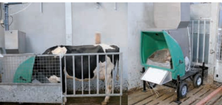
Foto 2: Nieuwe meettechnieken/meeettoestellen maken het mogelijk om de CH 4 - en CO 2 -uitstoot te meten in praktijkomstandigheden en niet langer enkel onder proefomstandigheden. Deze krachtvoederautomaat (GreenFeed, C-Lock) meet de CH 4 - en CO 2 -uitstoot wanneer het dier de automaat bezoekt tijdens het verblijf in de loopstal of het bezoek aan de melkrobot. ILVO beschikt over twee zo'n GreenFeed-eenheden.
